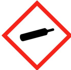
**Gambar 3.15 Simbol Kemasan Tabung Gas Bertekanan**
