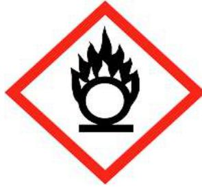
**Gambar 3.12 Simbol Kemasan Bahan Oksidator**
