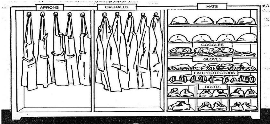
Gambar 1.45 Penempatan Perlengkapan Pakaian Dan Peralatan Keselamatan Kerja
