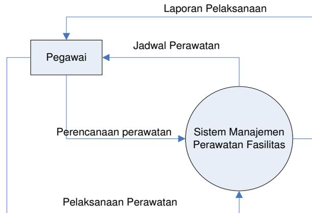
**Gambar 1.11 Diagram Konteks atau DFD Level 0**
