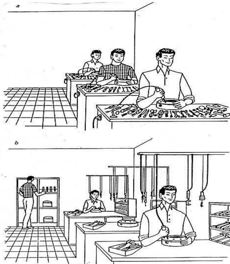
**Gambar 1.41 Penempatan Perkakas Dan Peralatan Kerja**
