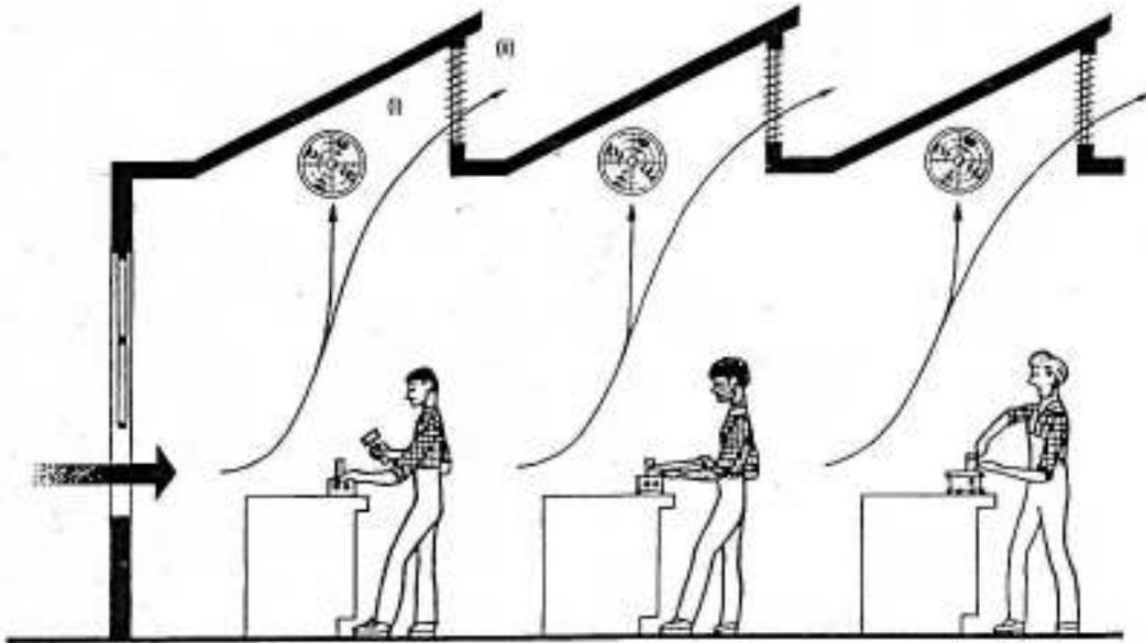
**Gambar 1.38 Sistem Ventilasi Gabungan Fan Penghisap Dan Atap Cahaya Jalusi**
